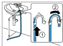
Đẩy ống mềm tháo nước hoàn toàn qua và cố định bằng đồ gá. Gắn chặt ống góp ở độ cao tối đa 100 cm.
