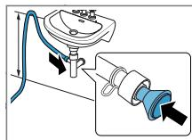
Cố định chắc chắn điểm nối bằng một kẹp ống mềm (12-22 mm). Gắn chặt ống mềm tháo nước với bộ phận dẫn ống mềm ở chiều cao tối thiểu 80 cm và tối đa 100 cm.
