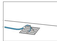
Đẩy ống mềm tháo nước hoàn toàn qua và cố định bằng đồ gá. Cố định ống góp trên rãnh nước.
