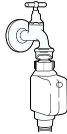
Ống cấp nước an toàn
